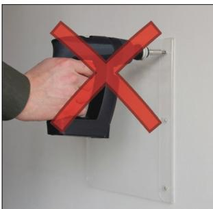
Schraube Sie mit einem Schraubenzieher die Schrauben handfest in die Dübel. Verwenden Sie keinen Elektro Bohrschrauber, da so evtl. die versenkung beschädigen können.
