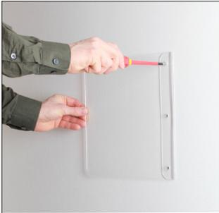
Markiere Sie die ausgewählte Stelle, wo Sie die Aufhängung montieren wollen. Falls erforderlich benutzen sie eine Wasserwaage. Bohren Sie mit einem 5 mm Bohrer Löcher in die Wand für die Dübel. Stecken Sie die Dübel in die Löcher. Nehmen Sie die Aufhängung mit der schmalen Seite zur Wand zeigend und positionieren Sie sie über die Bohrlöcher.
